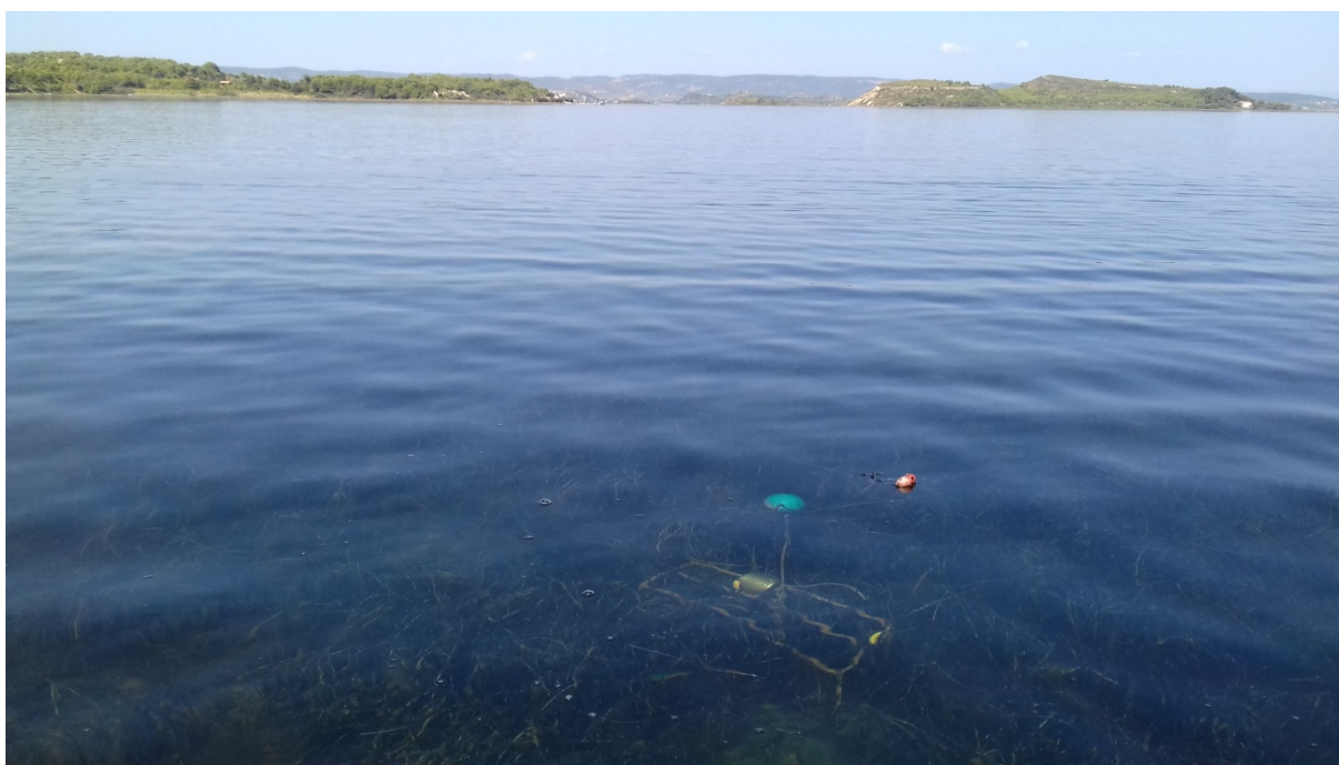
Figure 16 : Dispositif de suivi de la contamination chimique par échantillonneur passif (ici POCIS)
