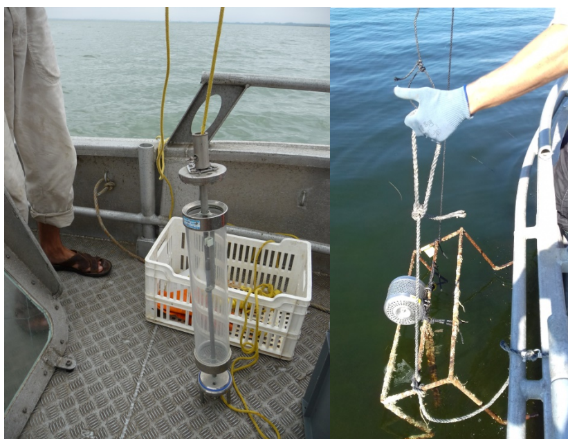
Figure 7 : Préleveur colonne d'eau (à gauche) et POCIS (Polar Organic Chemical Integrative Samplers) (à droite) utilisés dans le cadre d'OBSLAG « eutrophisation » et « pesticides »
